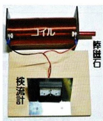
図3 コイルの中で磁石 (磁界)を動かすとコイル に電流が流れる様子 を見る実験
